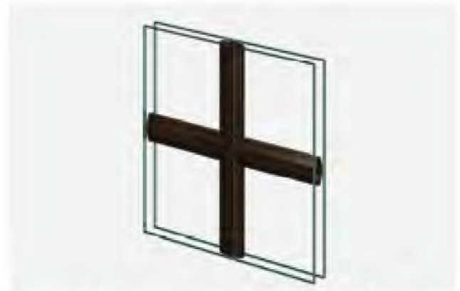
Sprosse im Scheibenzwischenraum (26 mm) in braun
